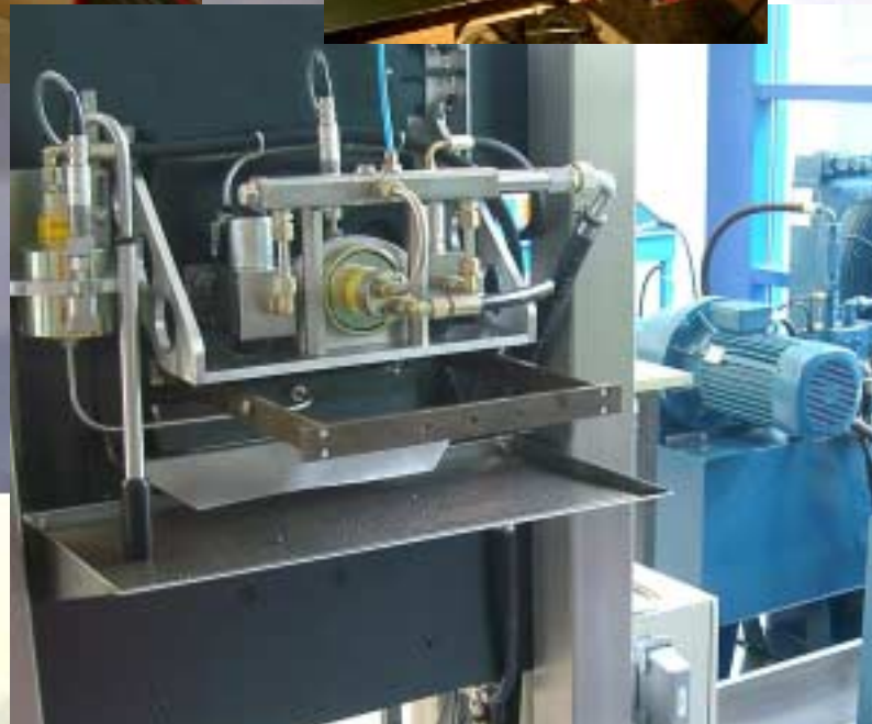
Hydroformpresse 14 MN Schließkraft Durchgangsbreite 250 mm, 2000 bar Umformdruck
